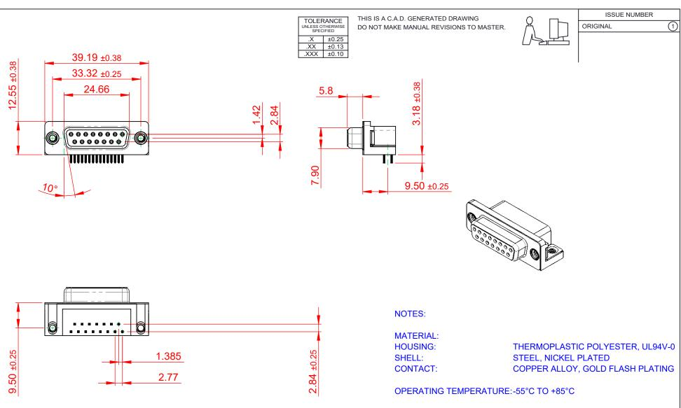
**CURRENT RATING:** CONTACT RESISTANCE:  $25m\Omega$  MAX. **INSULATOR RESISTANCE:** 5000MΩ min. DIELECTRIC
