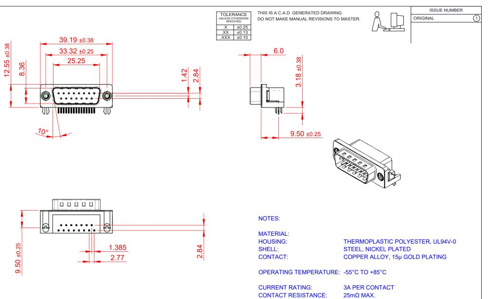
**INSULATOR RESISTANCE:** 5000MΩ min.
