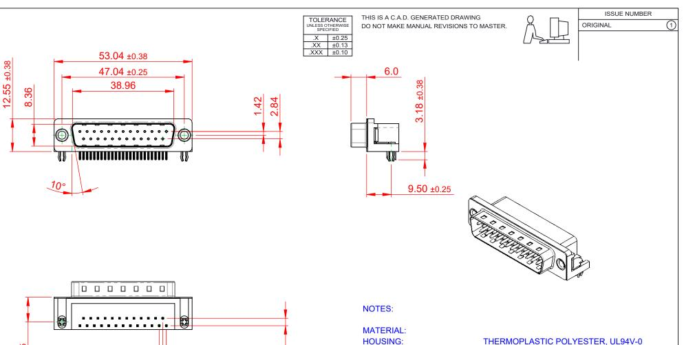
SHELL: CONTACT: STEEL, NICKEL PLATED COPPER ALLOY, 15µ GOLD PLATING
