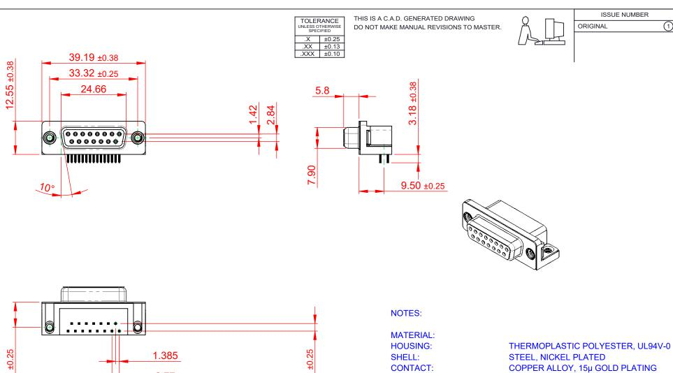
**CURRENT RATING: 3A PER CONTACT** CONTACT RESISTANCE: 25mΩ MAX. **INSULATOR RESISTANCE:** 5000MΩ min. DIELECTRIC
