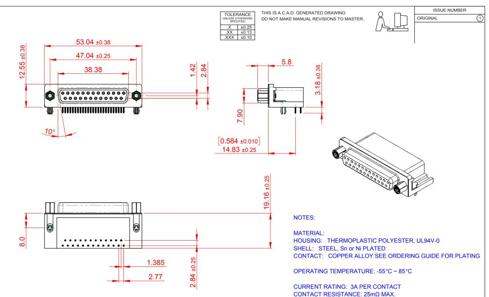
INSULATOR RESISTANCE:  $5000M\Omega$  min. **DIELECTRIC**
