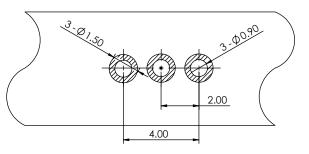
RECOMMENDED PCB LAYOUT (T:1.2mm) TOLERANCE UNSPECIFIED ±0.05mm
