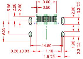
RECOMMENDED P.C.B LAYOUT CONNECTOR SIDE / TOP VIEW TOLERANCE: ±0.05
