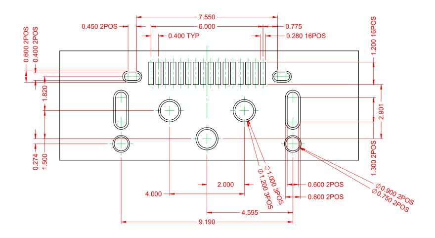
**RECOMMENDED P.C.B LAYOUT** TOP VIEW / COMPONENT SIDE
