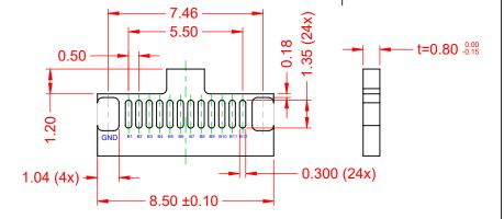
TOP AND BOTTOM SIDE RECCOMMENDED P.C.B.A (TOLERANCE:±0.05mm)
